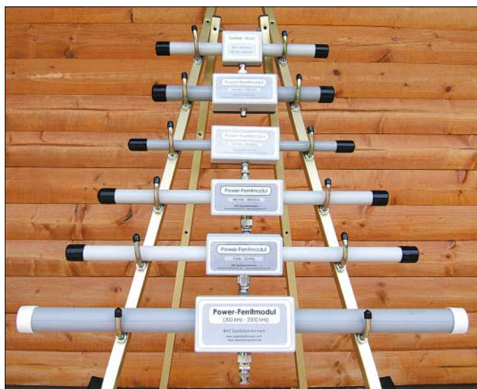
Bild 1: Das Bild zeigt eine Auswahl verschiedener Typen der BAZ-Power-Ferritmodule, die sich durch den Empfangsfrequenzbereich und die Leistungsklasse voneinander unterscheiden.
